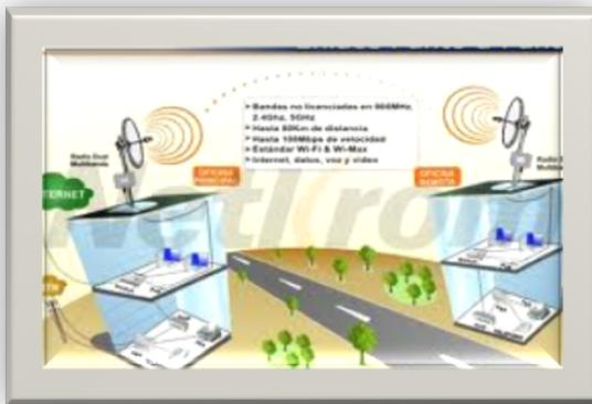
Se denomina radio enlace a cualquier interconexión entre los terminales de telecomunicaciones efectuados por ondas electromagnéticas.
